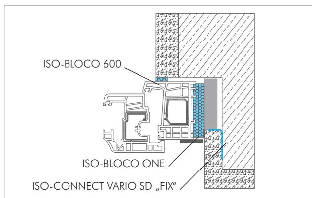
Esempio di installazione: ISO<sup>3</sup>-SISTEMA DI TENUTA PER FINESTRE
