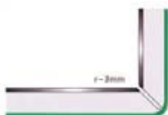
Fresatura a °90 (sagoma a V) per piegatura fino a 90°.
