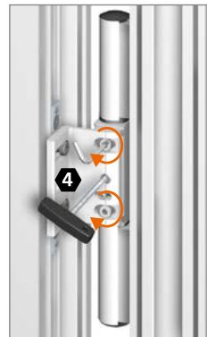
Apretar los tornillos de fijación con una segunda llave hexagonal (9–11 Nm).
