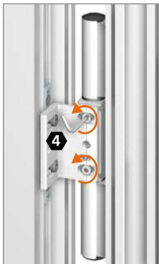
Aflojar los tornillos de fijación en el lado de la hoja.
