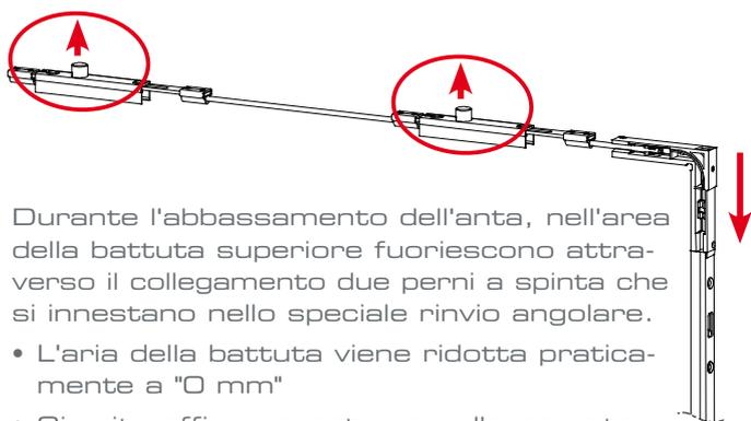
Durante l'abbassamento dell'anta, nell'area della battuta superiore fuoriescono attraverso il collegamento due perni a spinta che si innestano nello speciale rinvio angolare.
