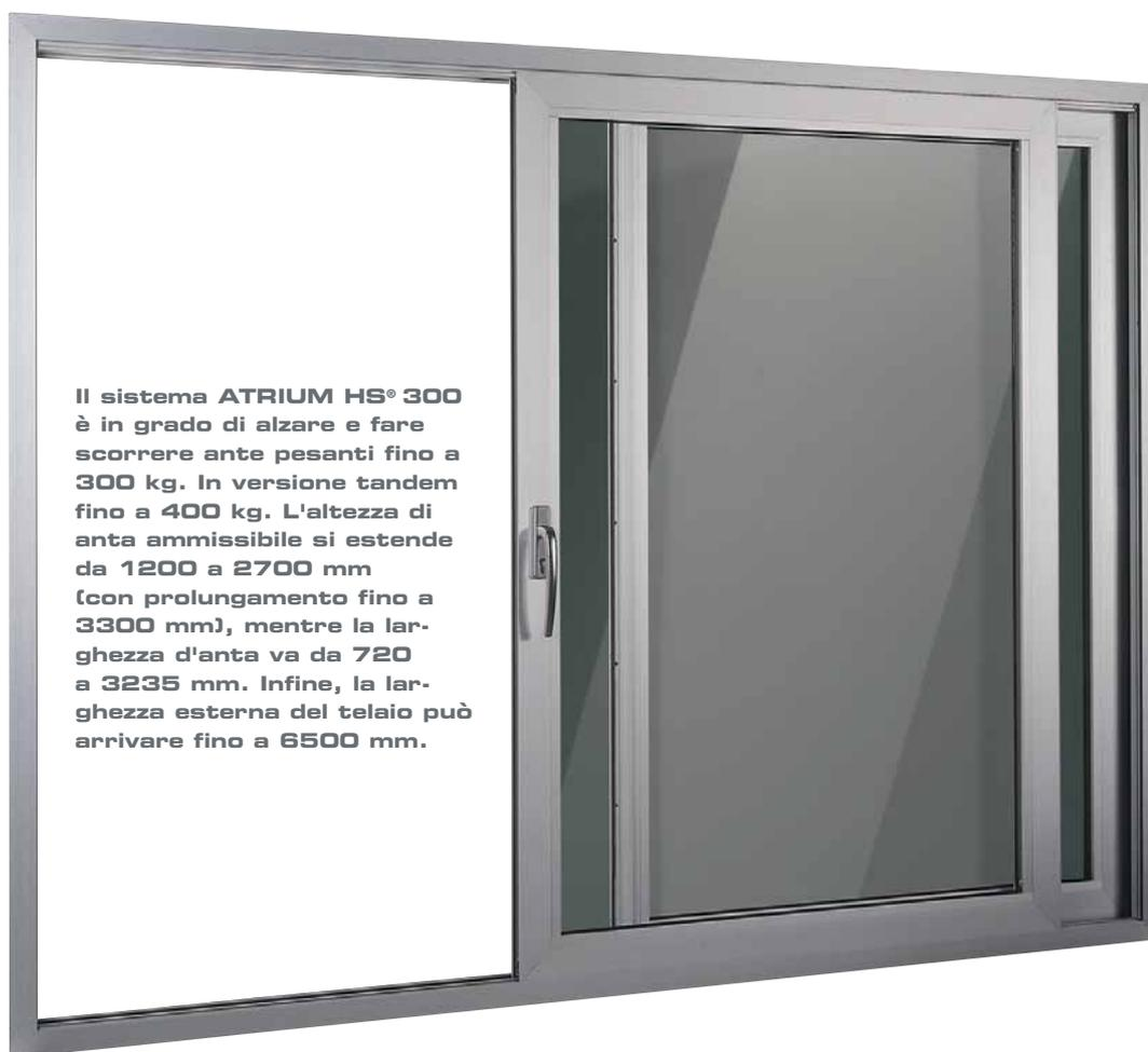
Il sistema **ATRIUM HS® 300** è in grado di alzare e fare scorrere ante pesanti fino a **300 kg**. In versione tandem fino a **400 kg**. L'altezza di anta ammissibile si estende da **1200 a 2700 mm** (con prolungamento fino a **3300 mm**), mentre la larghezza d'anta va da **720 a 3235 mm**. Infine, la larghezza esterna del telaio può arrivare fino a **6500 mm**.
